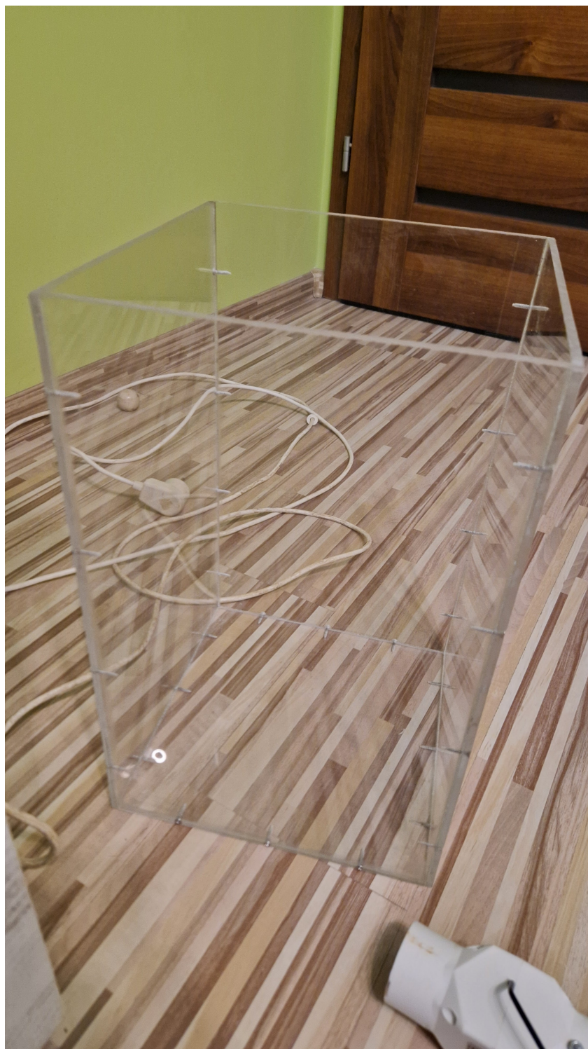
Rysunek 14: Zmontowana, szczelna obudowa główna wykonana z płyt pleksi
