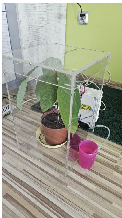
Rysunek 1: Zmontowany i działający prototyp Growboxa
