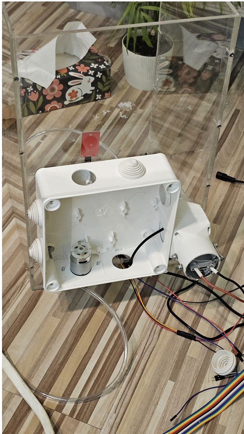
Rysunek 18: Puszka natynkowa przymocowana do obudowy z widocznym silnikiem pompy wewnątrz oraz wężykami wyprowadzonymi na zewnątrz
