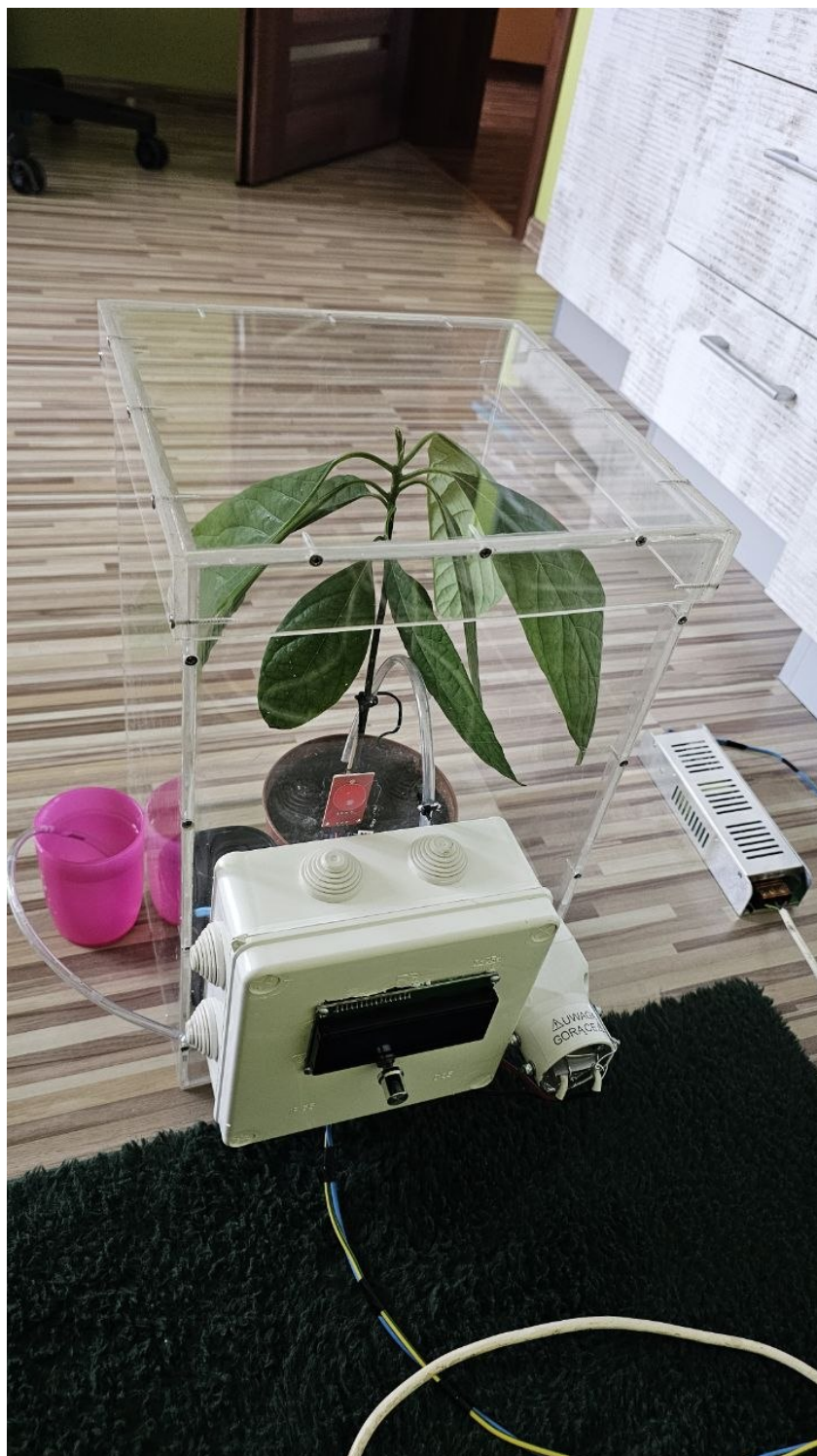
Rysunek 21: W pełni zmontowany, uruchomiony i funkcjonujący prototyp automatycznego systemu zarządzania mikroklimatem (Growbox)
