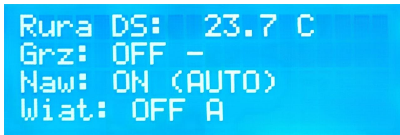
Rysunek 24: LCD — ekran pulpitu 1: temperatura rury i stan grzałki, nawilzacza, wiatraka
