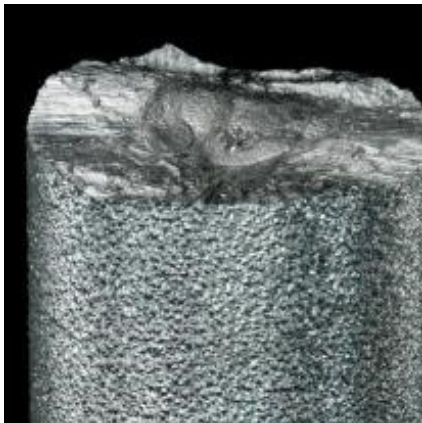
Pręt monokrystaliczny (średnica 5-7.5 cm)
