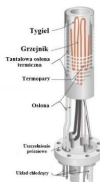
Rys. 1.20. Komórka efuzyjna systemu MBE
