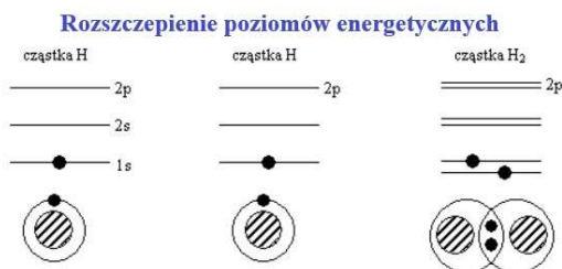
Rys. 1.3 Tworzenie cząsteczki wodoru
