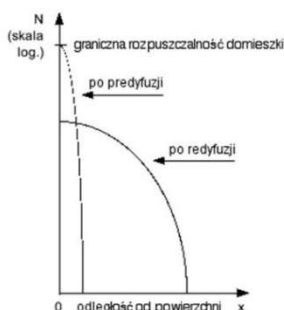
Rys. 1.18. Profile rozkładu koncentracji domieszek w technologii dyfuzyjnej.
