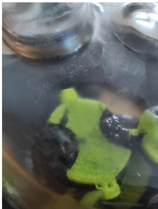
Odpowietrzanie zalanych form przygotowanym silikonem w próżni.
