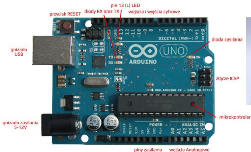
Rys. 2. wygląd płyty Arduino Uno i rozmieszczenie elementów
