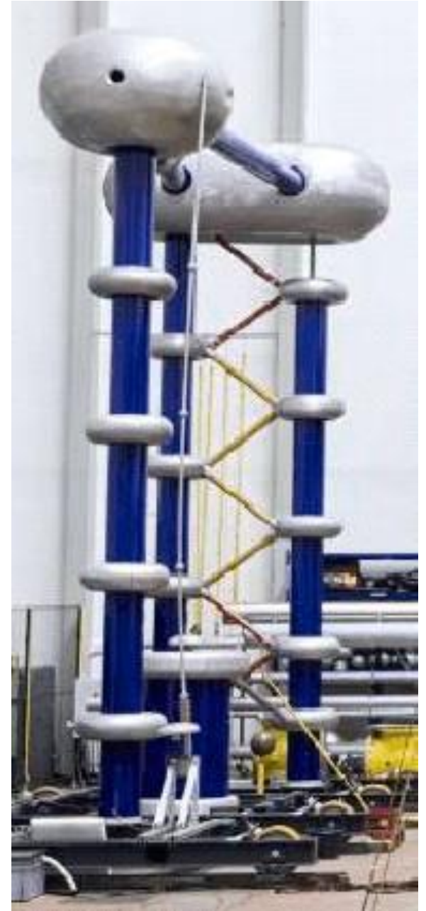
Generatory napięcia stałego 2 MV i 1,2 MV połączone z dzielnikami napięcia stałego
