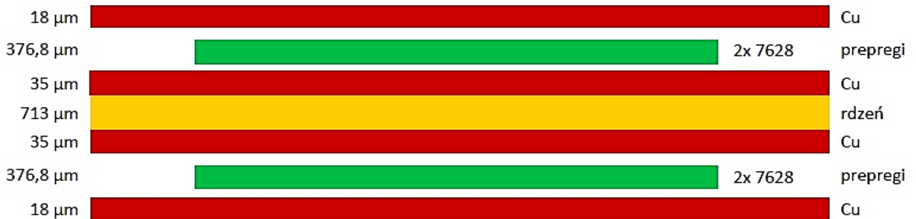
Zasada budowy obwodu czterowarstwowego
