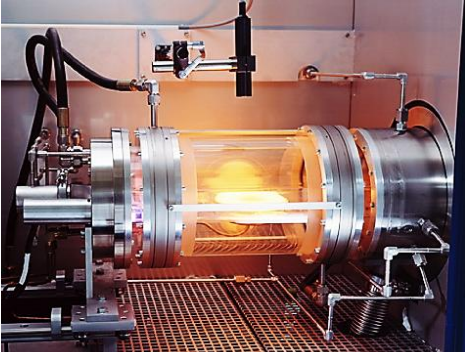
Komora do nakładania warstw epitaksjalnych z fazy gazowej związków metaloorganicznych (MOCVD)
