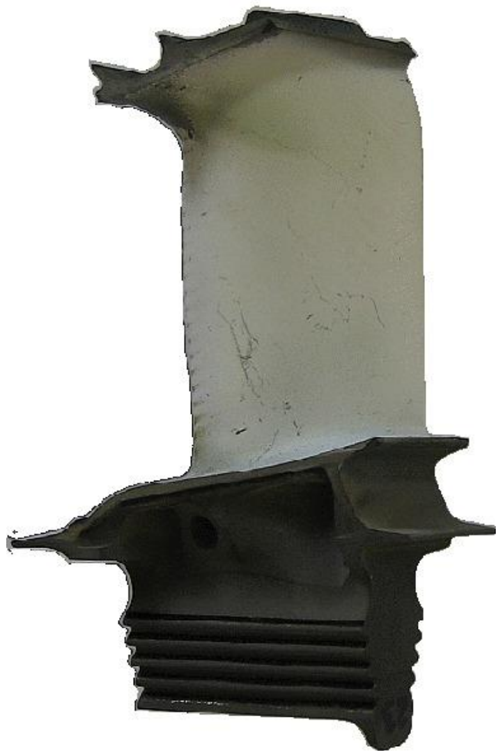
Łopatką turbiny z powłoką TBC
