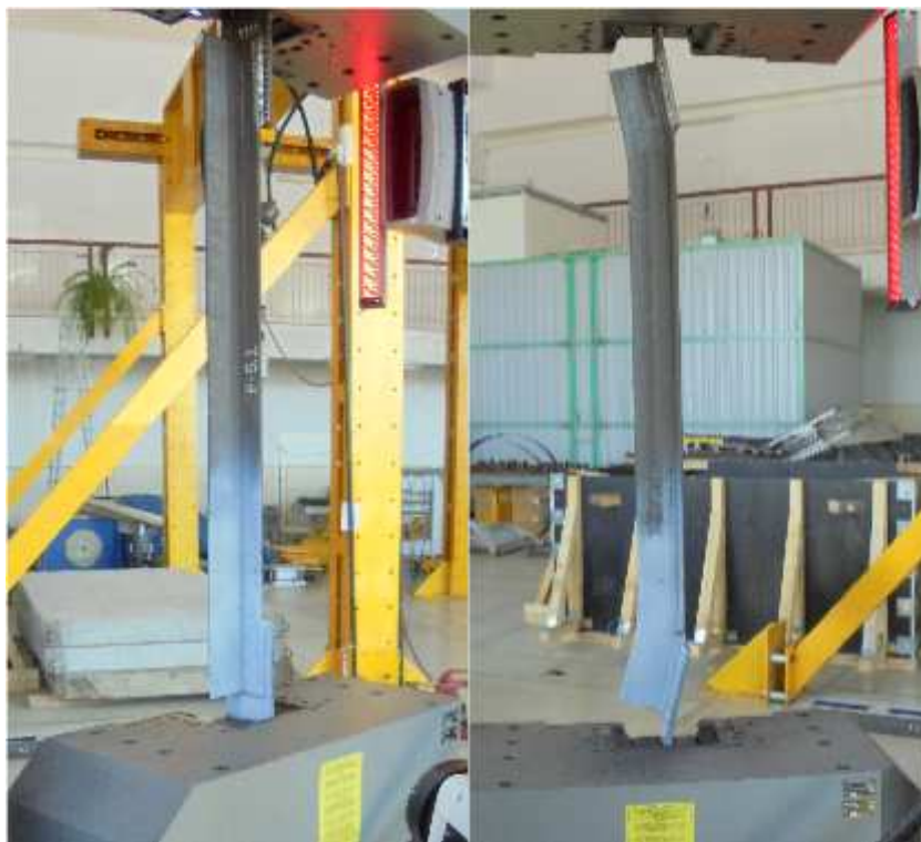
Rys. 4.5. Wygięcie próbki P-5 w czasie rozciągania w maszynie wytrzymałościowej
