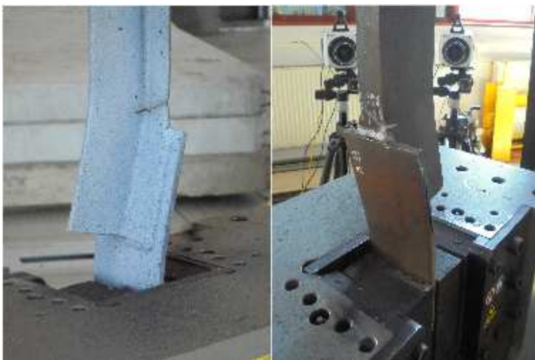
Rys. 4.6. Miejsce i forma zniszczenia próbki P-5
