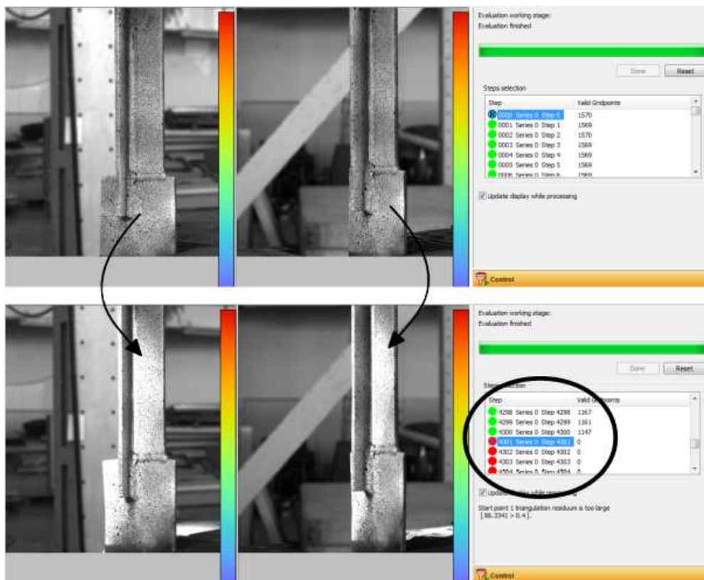
Rys. 2.4. Zatrzymanie procesu ewaluacji zarejestrowanych przez kamery obrazów spowodowane chwilową zmianą oświetlenia naturalnego – wzrostem intensywności światła słonecznego
