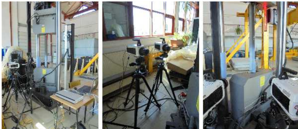
Rys. 4.2. Stanowisko pomiarowe przemieszczeń i odkształceń połączeń spawanych i prętów rozciąganych z mimośrodem za pomocą systemu Q-450 Dantec Dynamics
