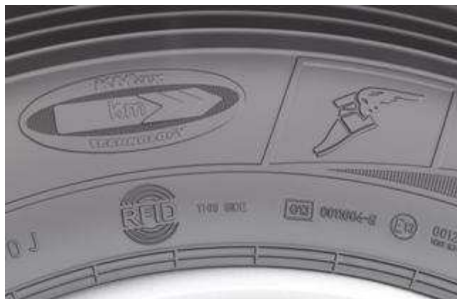
Rys. 2. Oznaczenie ściany bocznej opony lokalizujące mikrochip RFID.
