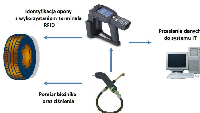
Rys. 3. Schemat audytu ogumienia z wykorzystaniem technologii RFID.
