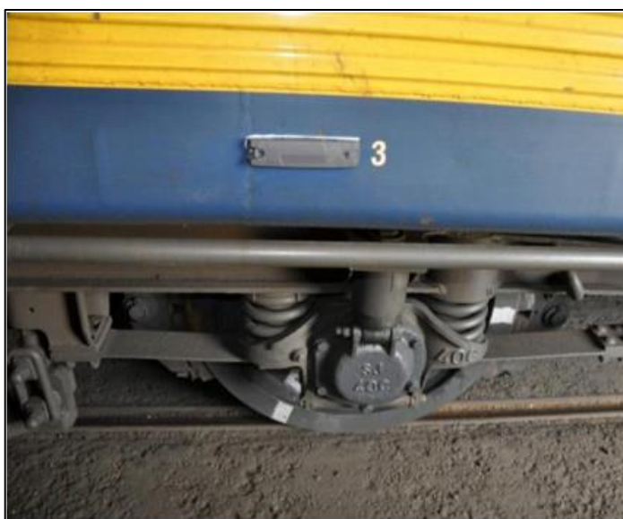
Rys. 3.12. Mocowanie transpondera pasywnego do pojazdu szynowego [18]
