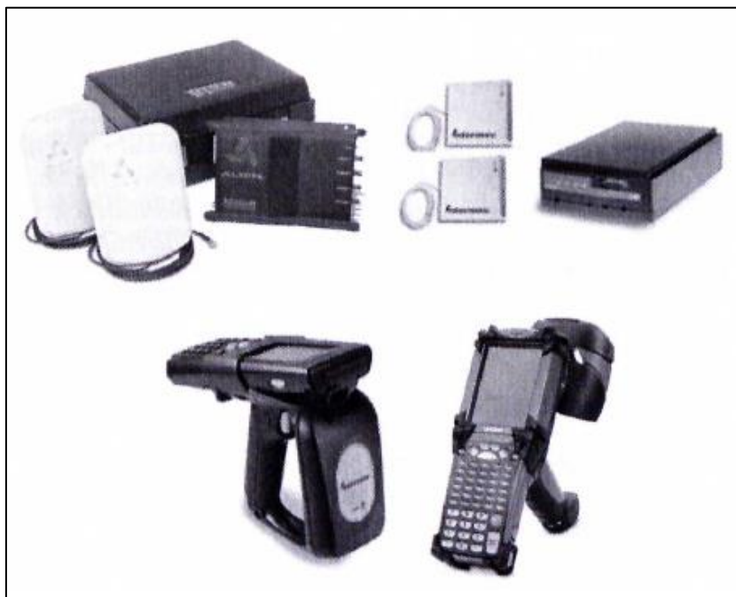
Rys. 2.6. Przykładowe stacjonarne i przenośne czytniki RFID [4]
