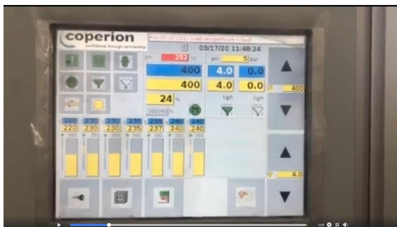
Rys. 4. Zadana temperatura poszczególnych stref cylindra i głowicy, obrotów ślimaka (400 1/min) oraz wydajność dozownika gravimetrycznego na 4 kg/h.
