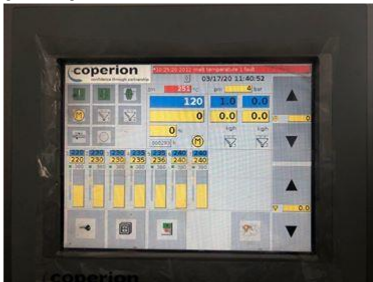
Rys. 2. Zadana temperatura poszczególnych stref cylindra i głowicy, obrotów ślimaka (120 1/min) oraz wydajność dozownika grawimetrycznego na 1 kg/h.
