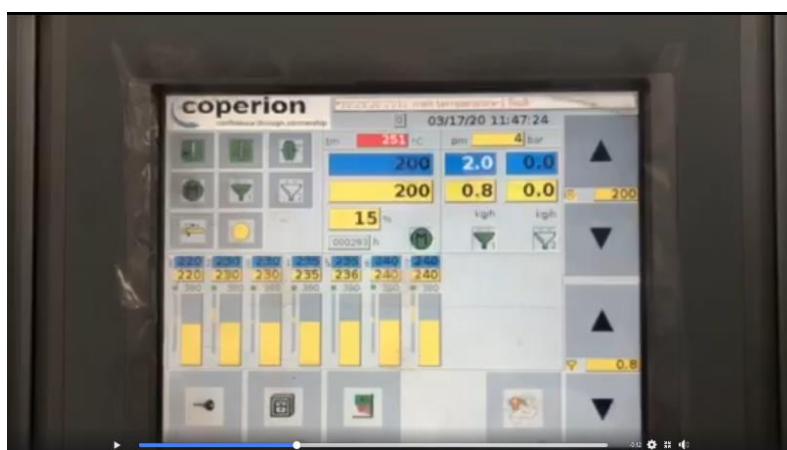
Rys. 3. Zadana temperatura poszczególnych stref cylindra i głowicy, obrotów ślimaka (200 1/min) oraz wydajność dozownika grawimetrycznego na 2 kg/h.
