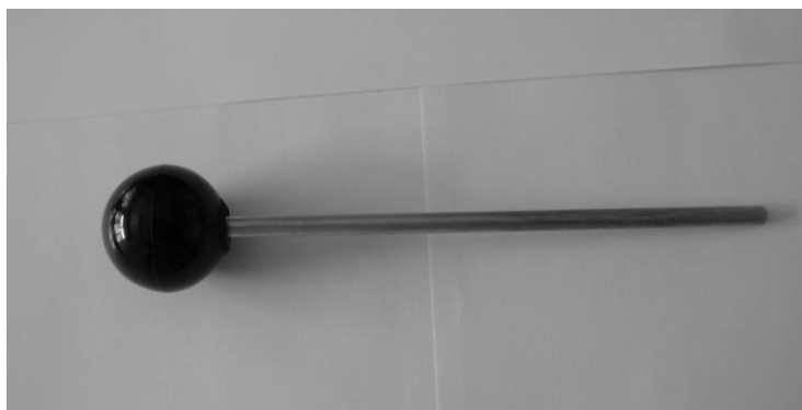
Fot.7.1.5 Wąski tłoczek do usuwania kapilary z cylindra
