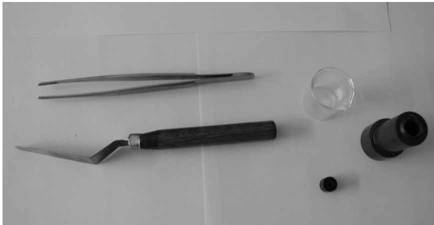
Fot.7.1.1 Zestaw urządzeń pomocniczych do wykonania ćwiczenia: 1-metalowa pęseta, 2-łopatka do odcinania, 3-zlewka, 4-kapilara, 5-ebonitowy lejek
