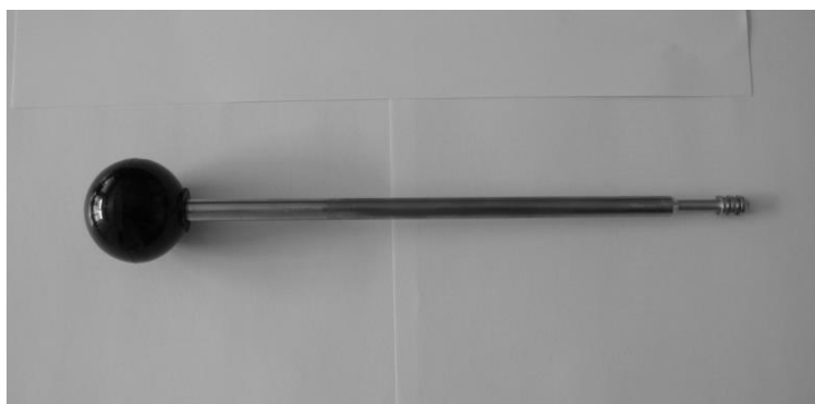
Fot.7.1.6 Karbowany tłoczek do czyszczenia cylindra
