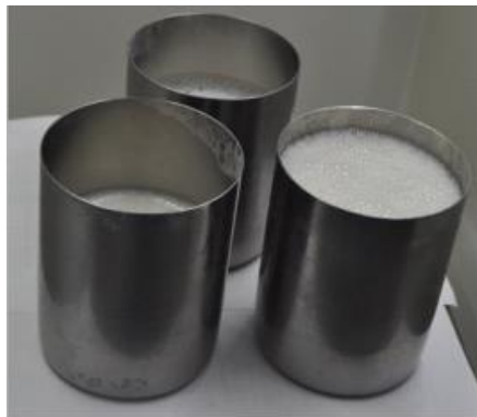
Rys. 3. Odgazowanie użytych do badań kompozycji za pomocą komory UGK500
