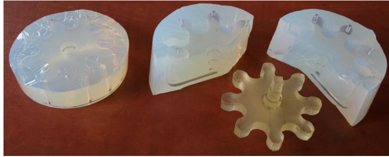
Rys. 4. Gotowa forma silikonowa i model SLA
