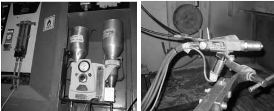
Rys. 4. Podajnik proszku 3M oraz pistolet 6P stosowane w procesie natryskiwania płomieniowego
