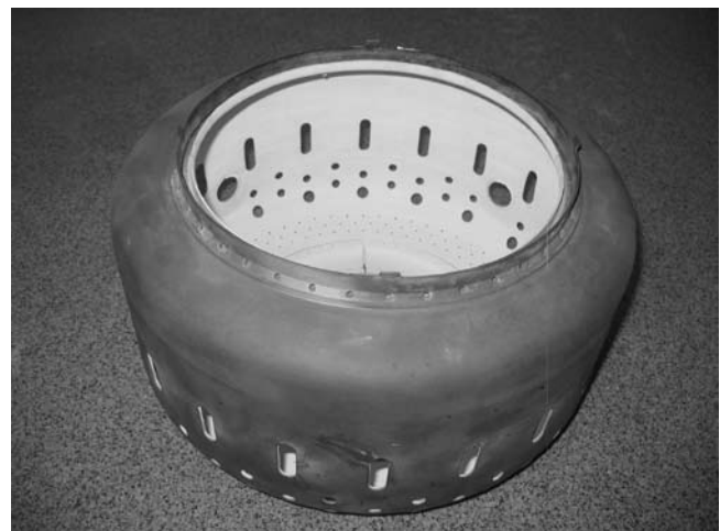
Rys. 6. Komora spalania z powłoką TBC Fig. 6. Combustion chamber with TBC coating
