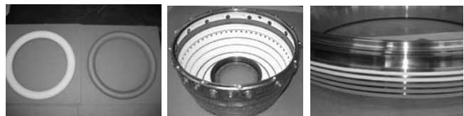
Przykłady elementów z wytworzoną na nich powłoką TBC
