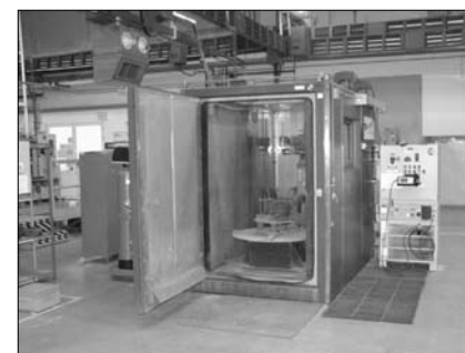
Rys. 10. Urządzenie do usuwania powłok natryskiwanych plazmowo Fig. 10. Device for Removal of Plasma Sprayed Coatings
