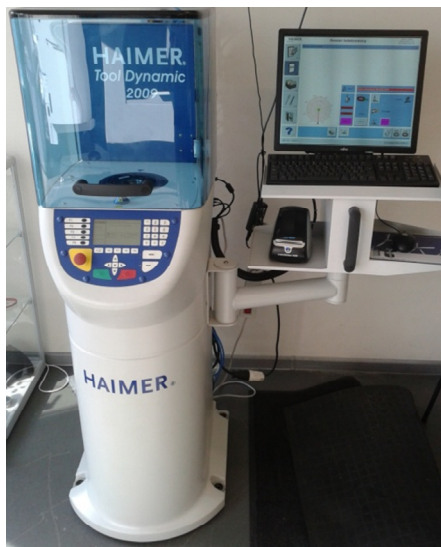
Rys. 9. Wyważarka do narzędzi: a) widok ogólny, b) widok pulpitu
