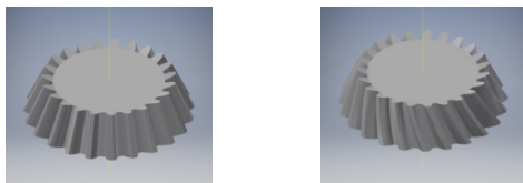
Rys. 8. Koła stożkowe: a) o zębach prostych, b) o zębach skośnych
