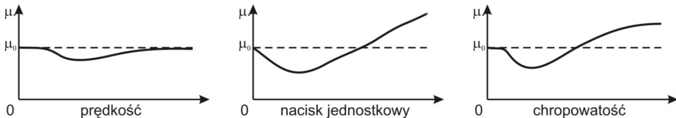
Rys. 9. Współczynnik tarcia suchego w funkcji: a) prędkości poślizgu, a) nacisków jednostkowych, a) chropowatości
