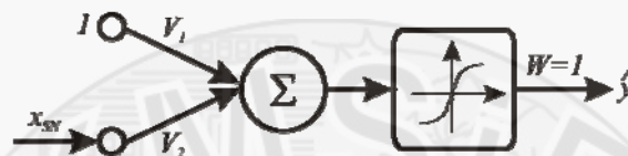
Rys. 1. Schemat SN zbudowanej z pojedynczego neuronu sigmoidalnego
