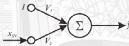
Rys.3. Schemat SN zbudowanej z pojedynczego neuronu liniowego
