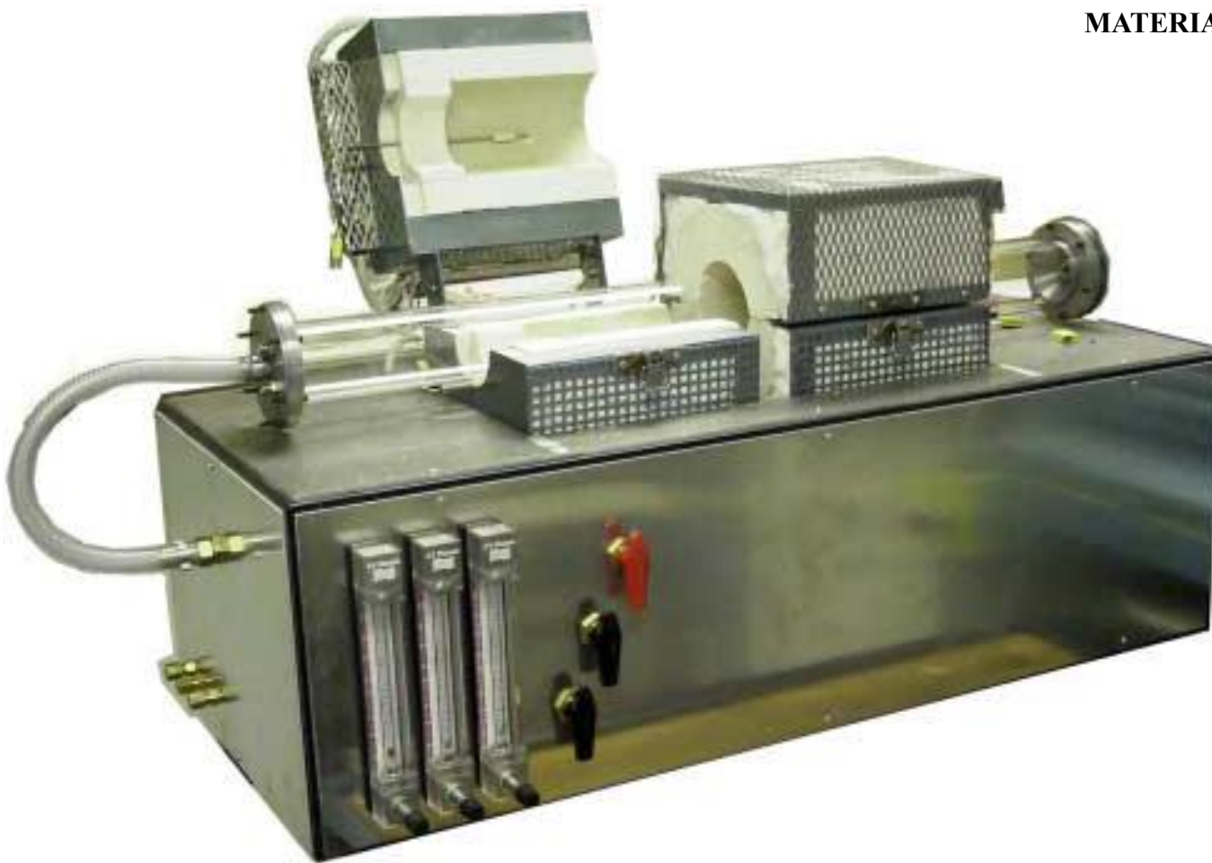
Komora do nakładania warstw epitaksjalnych z fazy gazowej związków metaloorganicznych (MOCVD)
