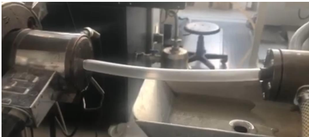
Rys. 5. Wyregulowany strumień powietrza włączany do głowicy – prawidłowa wytłoczka.
