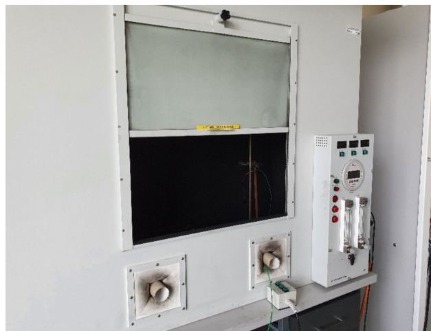
Rysunek 3. Komora do badania palności tworzyw polimerowych metodą UL94, firmy FFT
