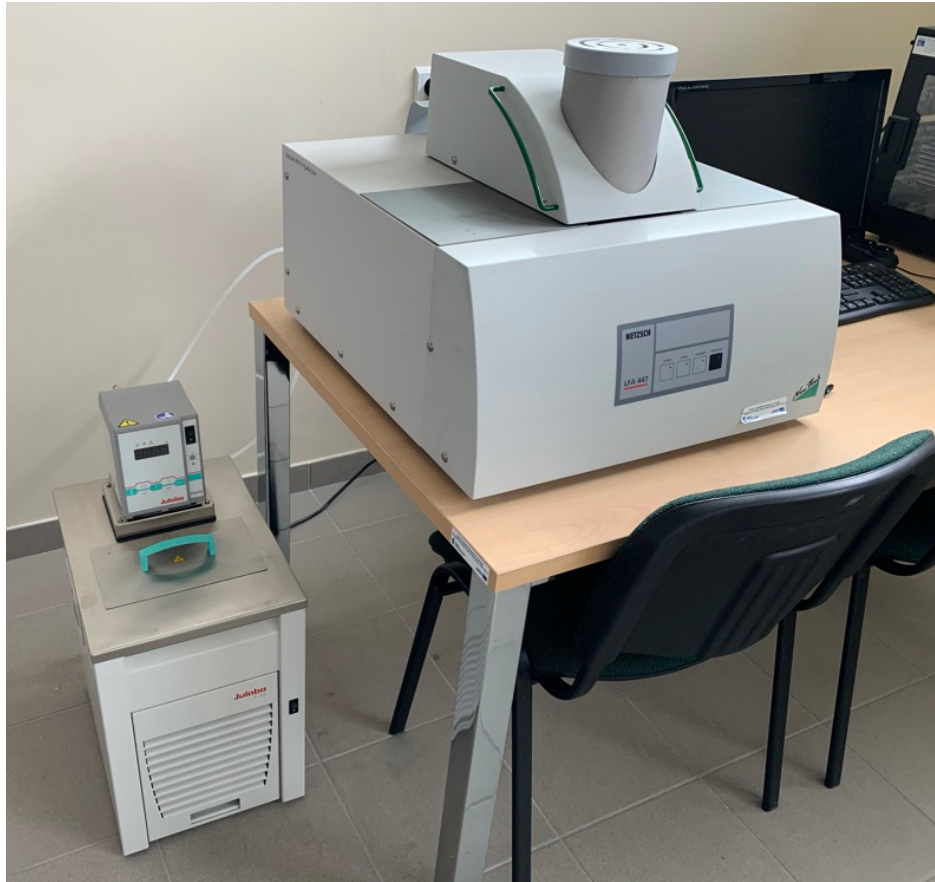
Rysunek 4. Aparat do pomiaru dyfuzyjności i przewodności cieplnej LFA 447 NanoFlash® z niskotemperaturowym cyrkulatorem grzewczo-chłodzącym JULABO F32
