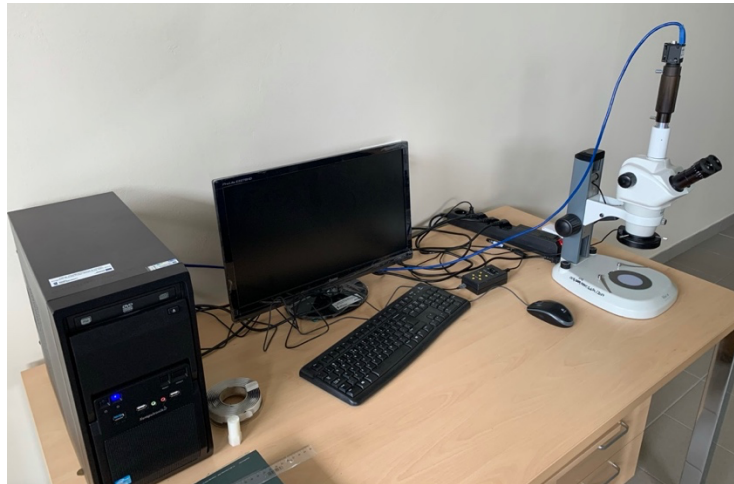
Rysunek 2. Stereoskopowy mikroskop inspekcyjny Vision SX45 z kamerą NikCam Pro-1 podłączony do zestawu komputerowego
