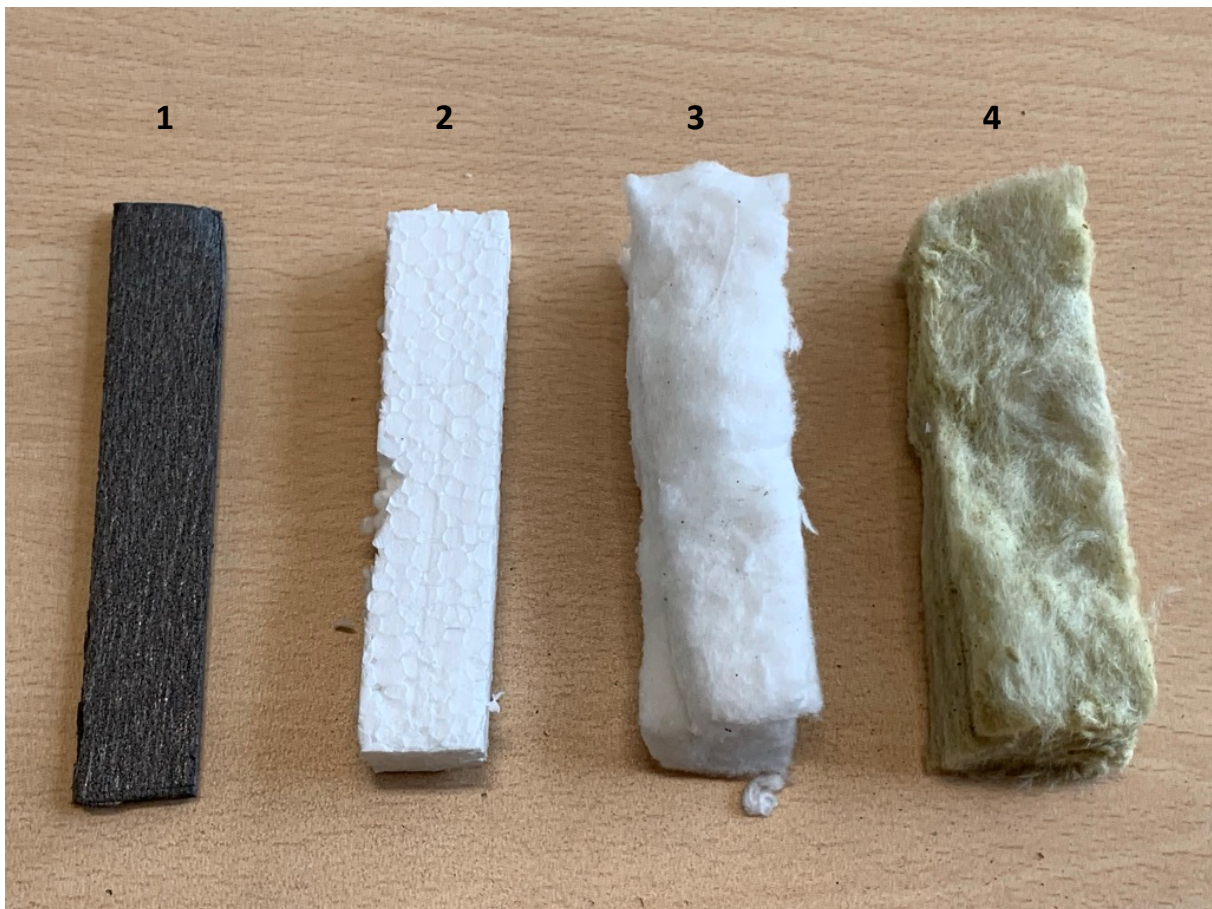
Rysunek 1. Próbkki wykorzystywane w przeprowadzonym ćwiczeniu do badań palności UL-94
