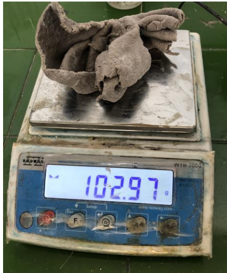
Rys. 3. Próbką krepą gumowej otrzymana w procesie walcowania.
