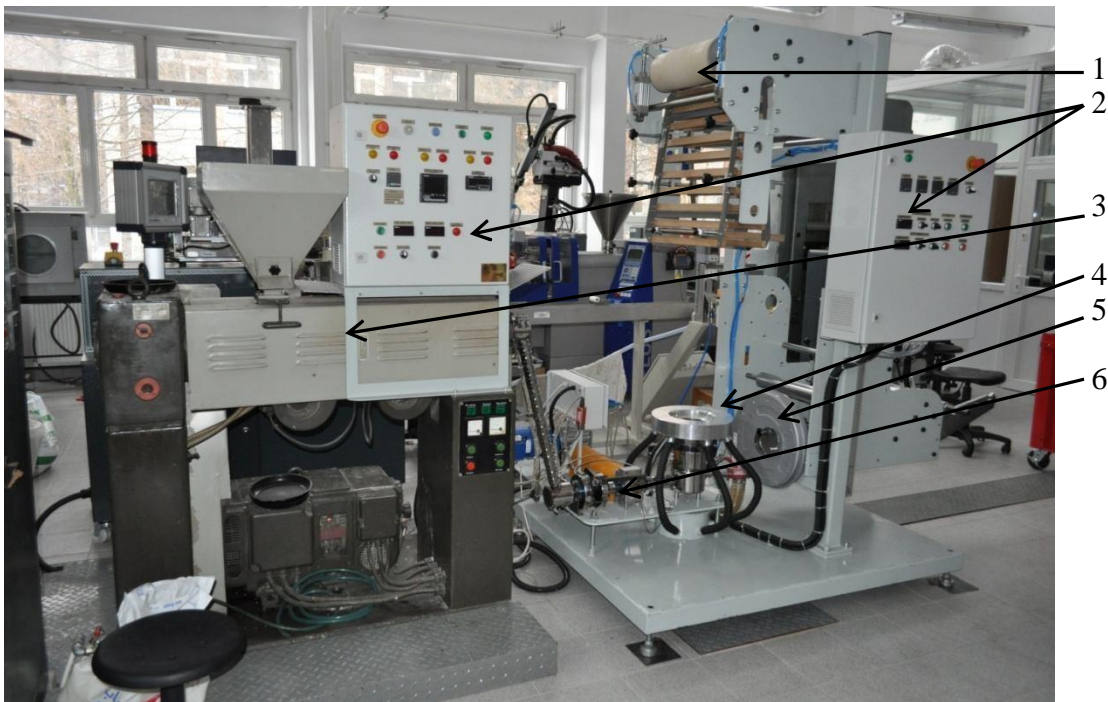
Rys. 1. Wygląd instalacji do wytwarzania folii z poliolefin metodą wytłaczania z rozdmuchem: 1- walce ciągnąco-odbierające wraz drabinką kierującą, 2- panele sterujące, 3- wytłaczarka T32 przystosowana do współpracy z linią rozdmuchu, 4- głowica krzyżowa, 5- wentylator powietrza schładzającego rękaw folii, 6- cylinder doprowadzający stop do głowicy z filtrem i pompą stopu.
