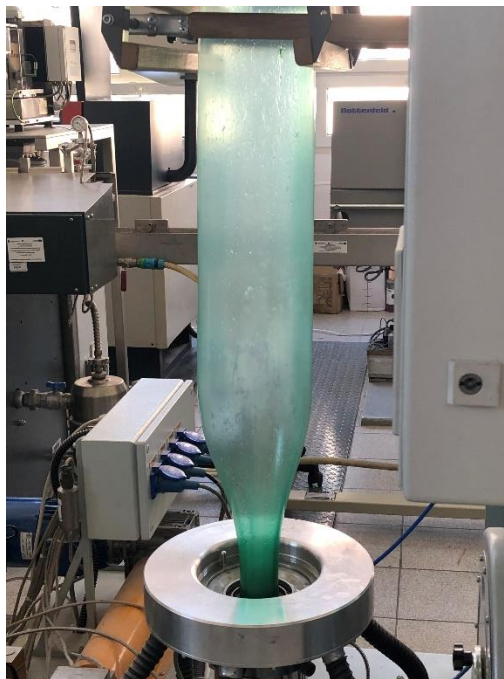
Rys. 2. Wytłaczana folia rękawowa.
