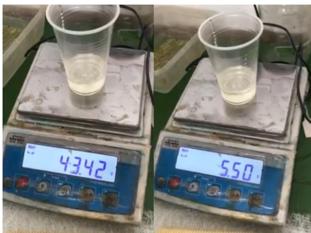
Rys. 1. Odważone ilości żywicy oraz utwardzacza przypadające na jedną warstwę tkaniny lub maty szklanej.
