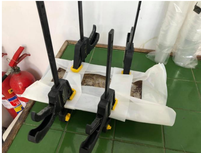
Rys. 4. Dociśnięte płytki stalowe za pomocą czterech ściskaczy stolarskich.
