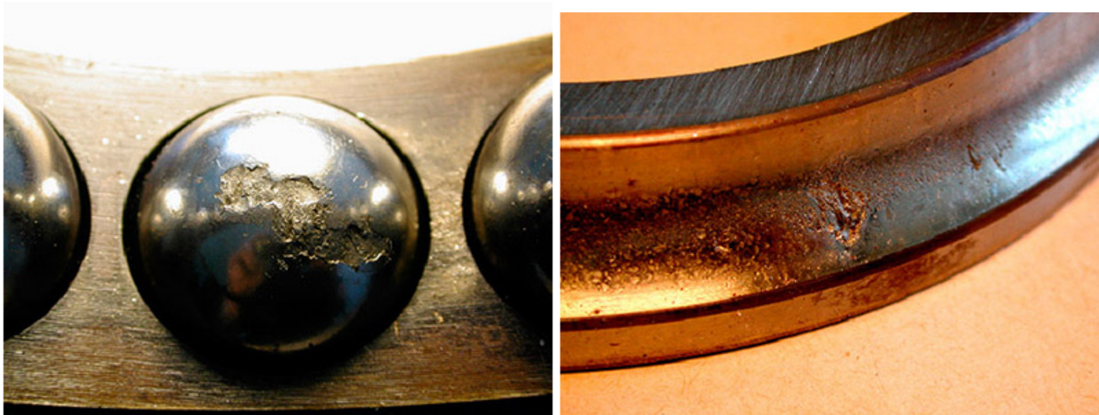
Widoczne zmęczenie materiałów elementu łożyska
