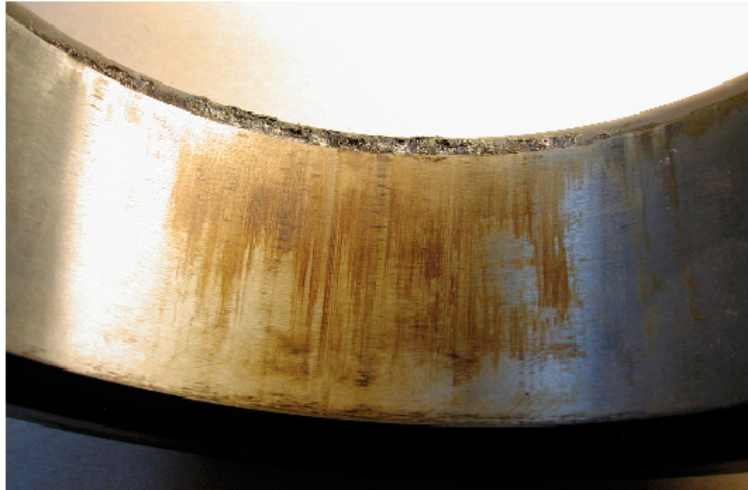
Zadarcia na bieżni zewnętrznej łożyska na skutek korozji
