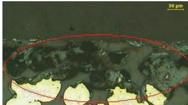
Uszkodzenie wskutek działania czynników chemicznych
