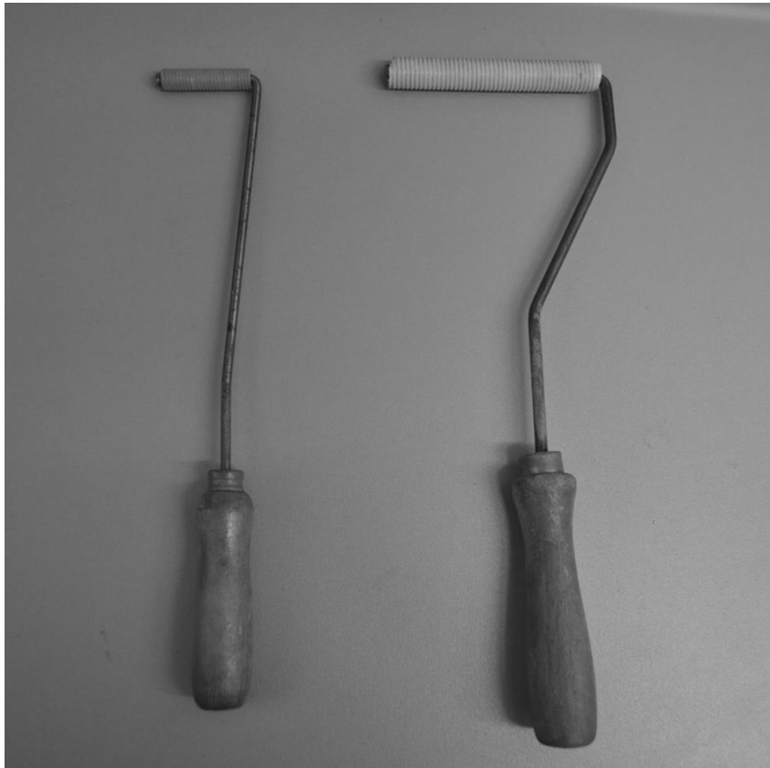
Fot.1. Widok wałków ryflowanych: z lewej - małego i z prawej - dużego.
