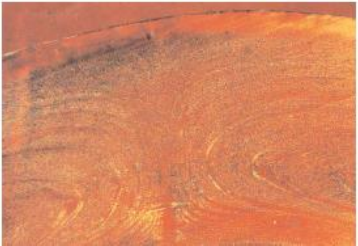
Rys. 5.71. Przekrój przez kształtkę z nienapełnionego PA6 w miejscu linii łączenia strumieni (zdjęcie otrzymane dzięki uprzejmości Pana Mariusza Makowskiego z firmy Du Pont)
