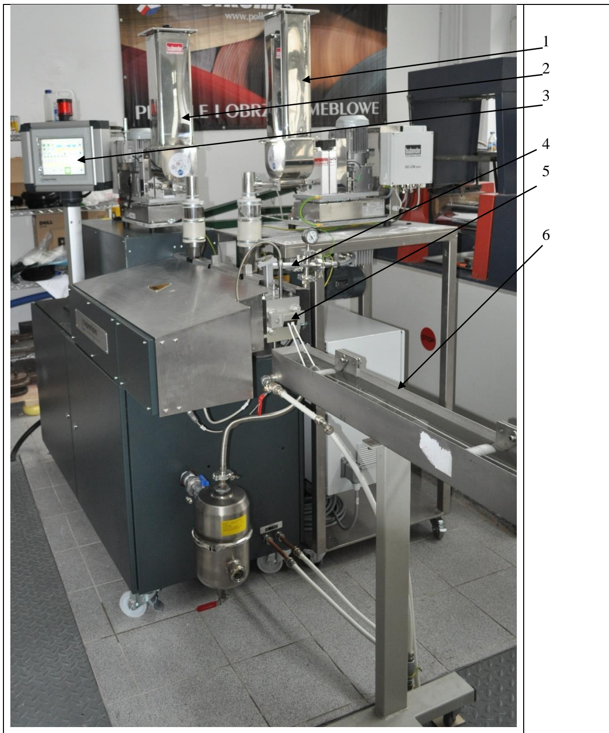
Rys. 4.13 Widok dwuślimakowej wylączarki mieszającej typu ZSK18 wraz z dozownikami grawimetrycznymi (1 – główny, 2 – boczny), otworem odgazowania próżniowego (4), głowicą prętową (5), wanną chłodzącą (6) i ekranem dotykowym panelu sterowania (3)
