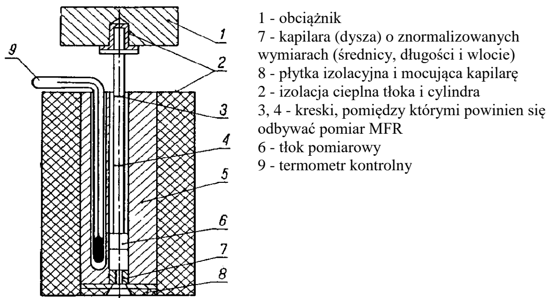
Rys. 2.1. Schemat plastometru obciążnikowego stosowanego do oznaczania wskaźnika szybkości płynięcia (MFR) stopionych lub upłynnionych polimerów
