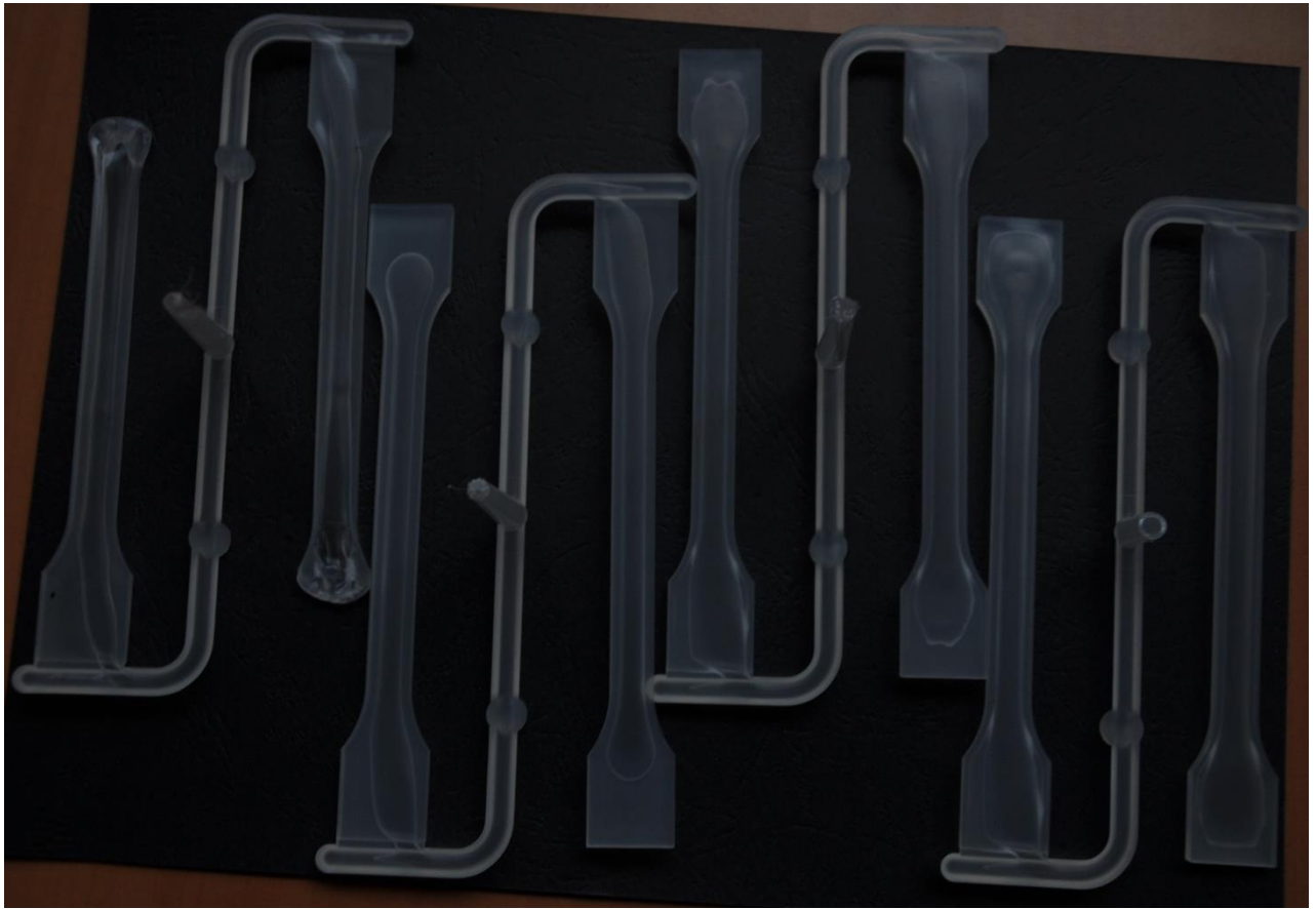
Rys.7.13.1. Widok wiosełek otrzymanych za pomocą technologii wtrysku z gazem.
