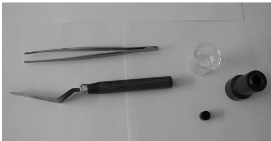
Fot.7.1.1 Zestaw urządzeń pomocniczych do wykonania ćwiczenia: 1-metalowa pinceta, 2-łopatka do odcinania, 3-zlewka, 4-kapilara, 5-ebonitowy lejek
