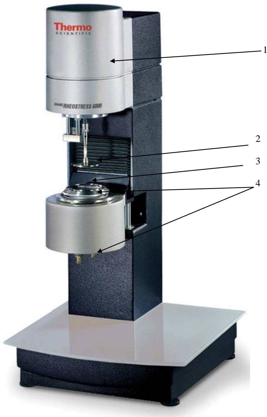
Rys. 2.8. Widok reometru oscylacyjno-obrotowego typu RheoStress 6000 przystosowanego do pomiarów reologicznych polimerów zdolnych do sieciowania
