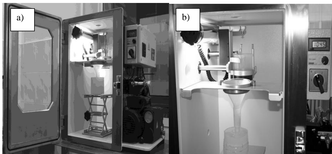
Rys. 7.19.3. Odlewanie próżniowe żywicy polimerowej w komorze maszyny próżniowej: a) aparatura próżniowa, b) odlewanie żywicy polimerowej do formy silikonowej.
