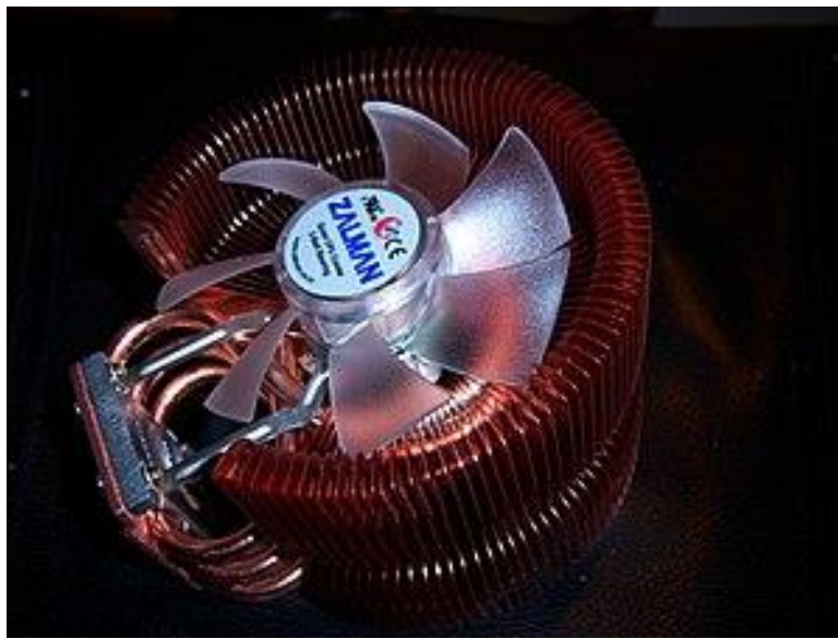
Radiator z wentylatorem, wyposażony w heat-pipe
